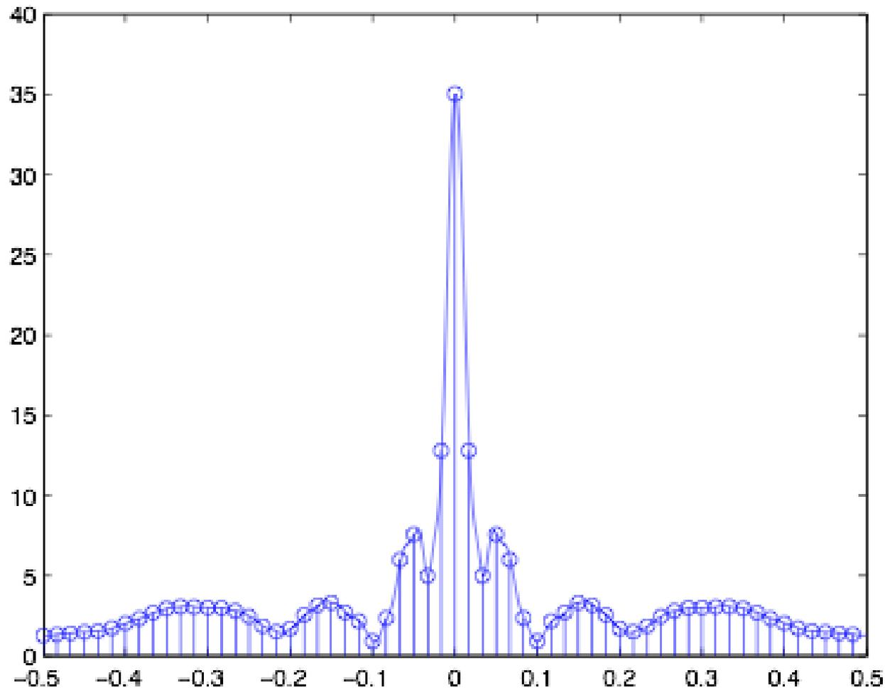
Superposition de TFD et TFtD. Des que  $M \geq N$  la TFD est un échantillonnage *parfait* de la TFtD
