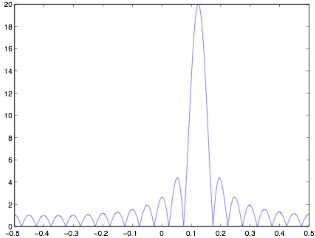
TFtD d'une onde de fréquence 0,123 tronquée à 20 échantillons.
